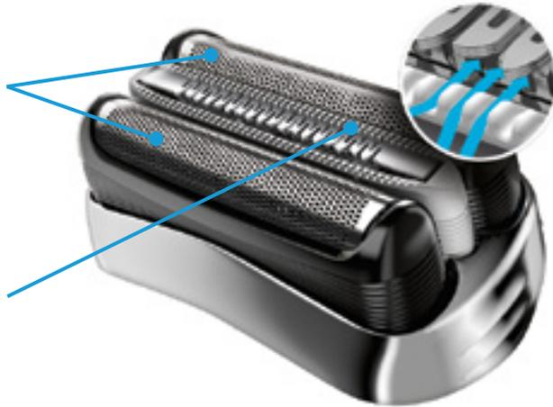
Der Scherkopf besteht aus zwei Folienelementen außen und einem Mitteltrimmer dazwischen. Die beiden Folien erfassen mühelos kurze Haare. Der Mitteltrimmer schneidet längere Haare vor, damit sie im selben Zug von den Scheren abgeschnitten werden können.
